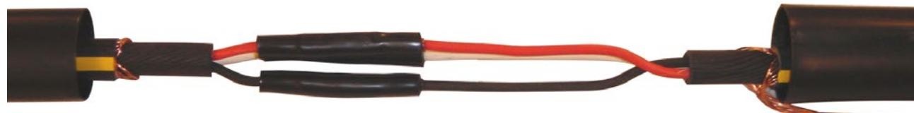
Einzeladern und Kabelmantel fettfrei reinigen.
