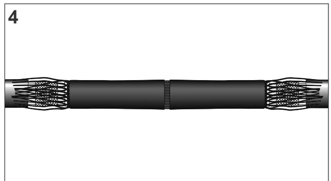
Cu-Schirmgeflecht mit den Spannbändern (System Ligarex) über Cu-Gewebeband befestigen.
