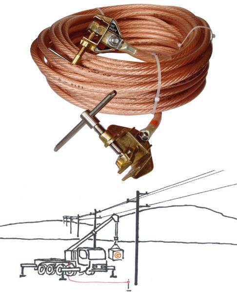
Cette corde de mise à la terre a été développée spécialement pour travaux avec les grues près des lignes aériennes. Pour éviter que votre grue soit sous tension par un contact involontaire, cette corde de mise à la terre se fixe à la grue et l'autre côté au mât mis à la terre ou à un piquet de terre. Pour une sécurité optimale des étaux solides sont montés aux deux extrémités.
