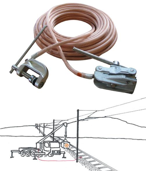
Garniture selon la norme CFF. Cette corde de mise à la terre a été développée spécialement pour travaux avec les grues près des caténaires. Pour éviter que votre grue soit sous tension par un contact involontaire, cette corde de mise à la terre se fixe à la grue et l'autre côté au rail mis à la terre. Pour une sécurité optimale et un montage rapide des étaux solides sont montés aux deux extrémités.
